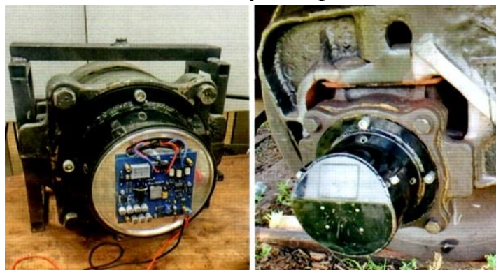
Рисунок 2. Внешний вид буксового устройства контроля БУК-В и установка его на тележку грузового вагона
