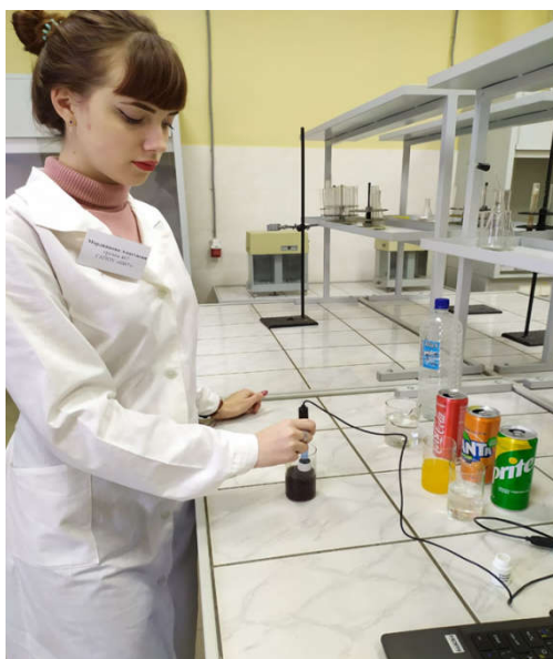
Рис. 8 Измерение кислотности газированных напитков с помощью цифрового датчика
