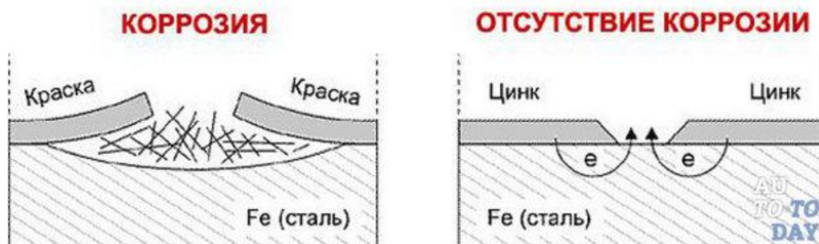
Рисунок 4 - Защита от коррозии методом цинкования.
