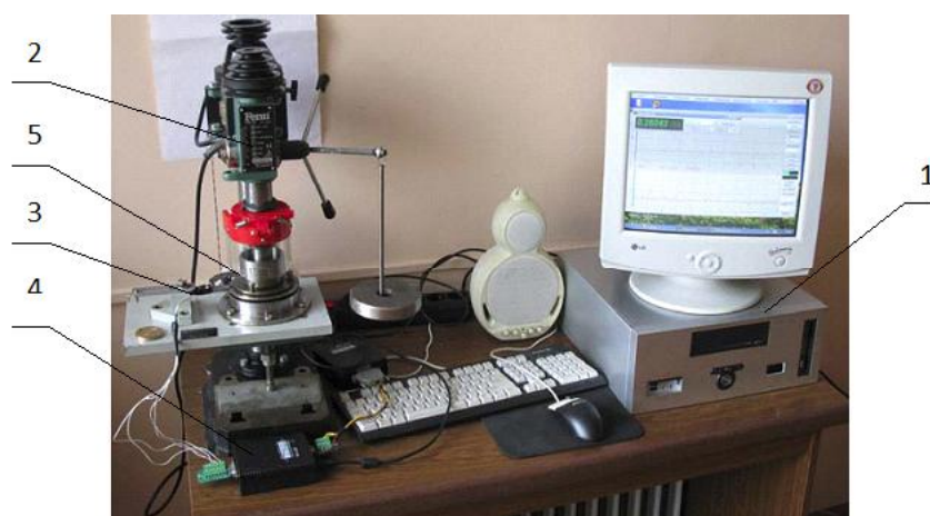
Рисунок 1 – Общий вид универсальной машины трения МТУ-01:
