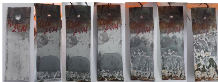
Рисунок 5 Динамика развития коррозии пластины с выдержкой t=25\text{минут} , I=0,1\text{A} . Периодичность фотографирования 1неделя.
