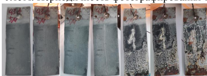
Рисунок 7 Динамика развития коррозии пластины с выдержкой t=5\text{минут} , I=0,3\text{A} . Периодичность фотографирования 1неделя.
