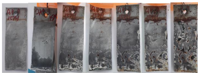
Рисунок 8 Динамика развития коррозии пластины с выдержкой t=15 минут, I=0.4 А. Периодичность фотографирования 1 неделя.
