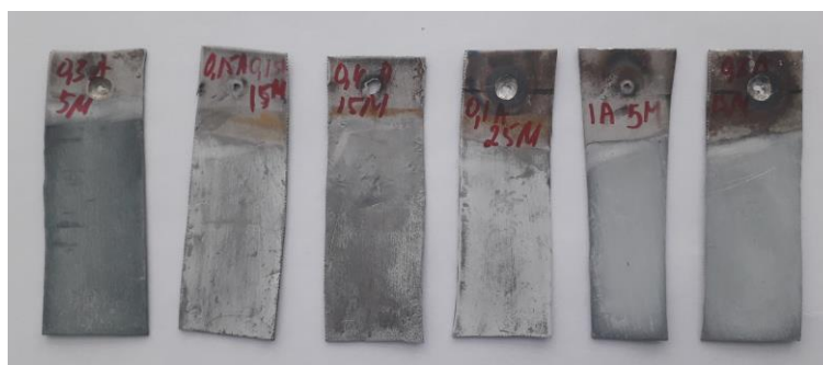
Рисунок 4 Оцинкованные пластины после цинкования
