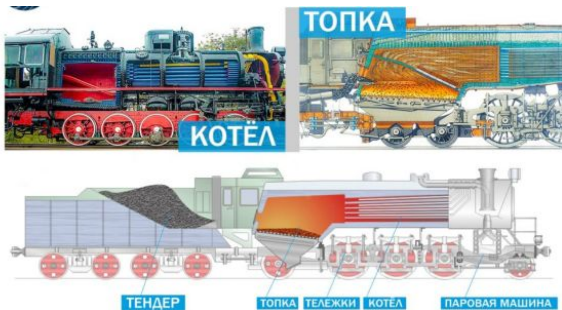
Рис.2. Устройство паровоза
